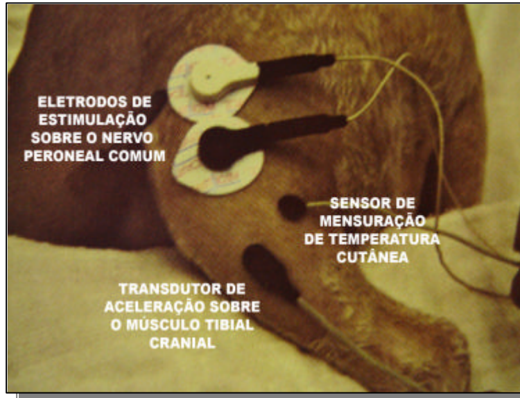
Figura 1 - Posicionamento das diferentes seções do estimulador de nervo periférico TOF-WATCH S® no membro posterior esquerdo de um canino (FANTONI, CORTOPASSI, 2002).
